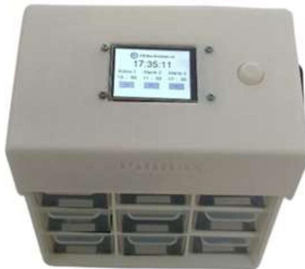
Gambar 7. Hasil Integrasi Rangkaian Elektronik Pada Housing *Pillbox*
