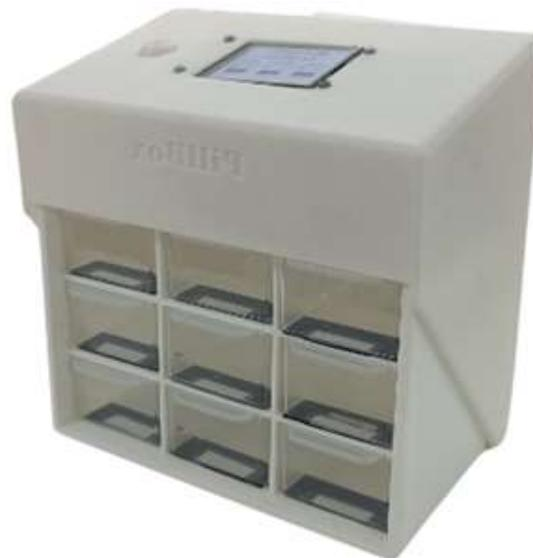
Gambar 3. Hasil Cetak Desain *Pillbox* Menggunakan 3D Printer
